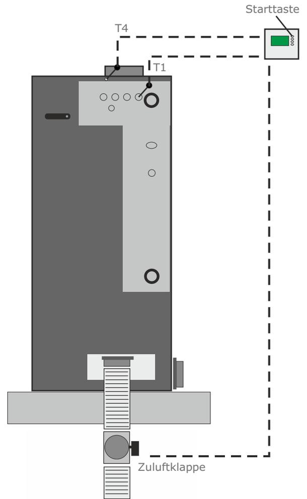
Zuluftklappe elektrisch gesteuert
