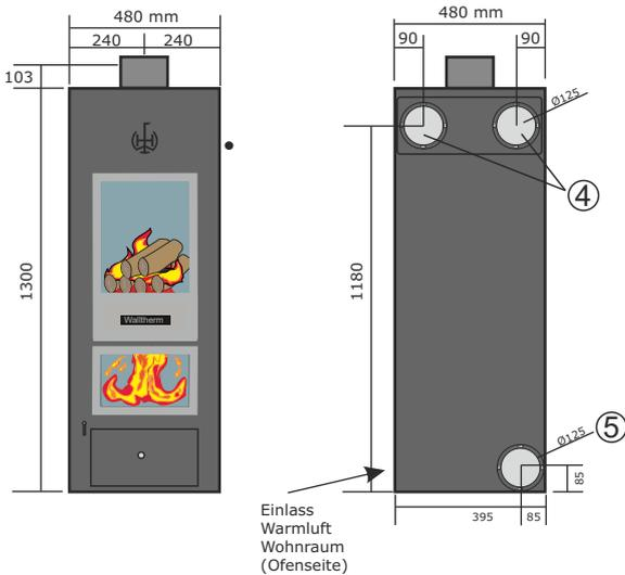
Adapter Ø 125 mm für rückseitige Warmluftweiterleitung od. ext. Verbrennungsluftkanal rückseitig
